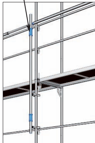
Рис. 12 и 13: Присоединение дополнительного поручня к раме Speedy
