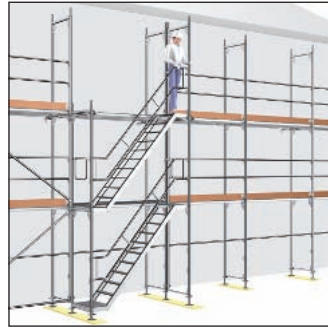
Рис. 54: Установка поручня лестницы
