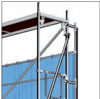
Рис. 118: Пример монтажа тентов Keder.
